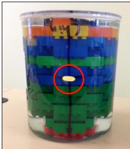
2) Placer le fantôme sur l'appuie-tête, avec la plus large extrémité marquée "Chin" à l'extérieur. Tourner le fantôme afin de voir l'inscription "Chin" vers le haut. S'assurer que le fantôme est poussé au maximum au fond de l'antenne. Après avoir fermé l'antenne, une portion d'environ 10 cm dépassera de l'antenne (parfois plus avec les antennes Philips). Aligner le fantôme afin que la partie la plus large de la croix pointe de bas en haut (verticalement).
